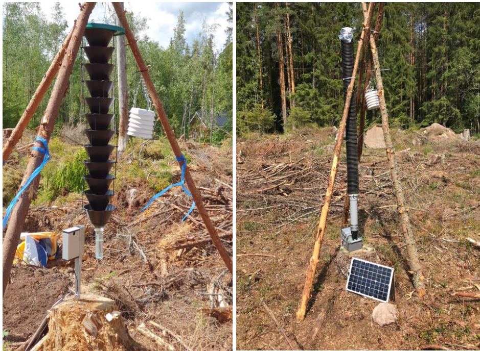
Kuva 1. Kaksi erityyppistä pilottiansaa maastotestauksessa Pukarossa ja Liljendahlissa. Ansoissa hyödynnettiin kahta erilaista ”maastokestävää” matkapuhelinmallia, joiden toiminnallisuutta testattiin kuumissa olosuhteissa. Matkapuhelimien virranlähteeksi laitettiin edulliset aurinkopaneelit, jotka lataisivat varavirtalähteitä, joita pystyttiin hoitamaan langattomasti. Kuvat: Simo Seppälä/Yield Systems Oy.
